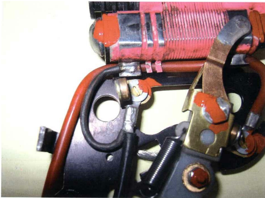
Einbau eines zusätzlichen Bremskabels. Zur Übersicht wurde die Reglerfeder ausgehakt, damit man das zusätzliche Bremskabel und die Kabelführung des roten Vollgaskabels besser erkennt.
