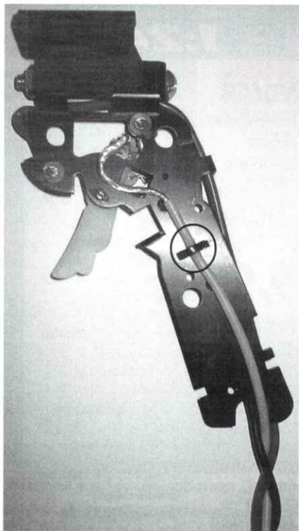
Die zweckmäßige Kabelführung auf der linken Rahmenseite.
