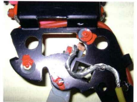
Mit Schraubensicherung fixierte Schrauben der linken Reglerseite.
